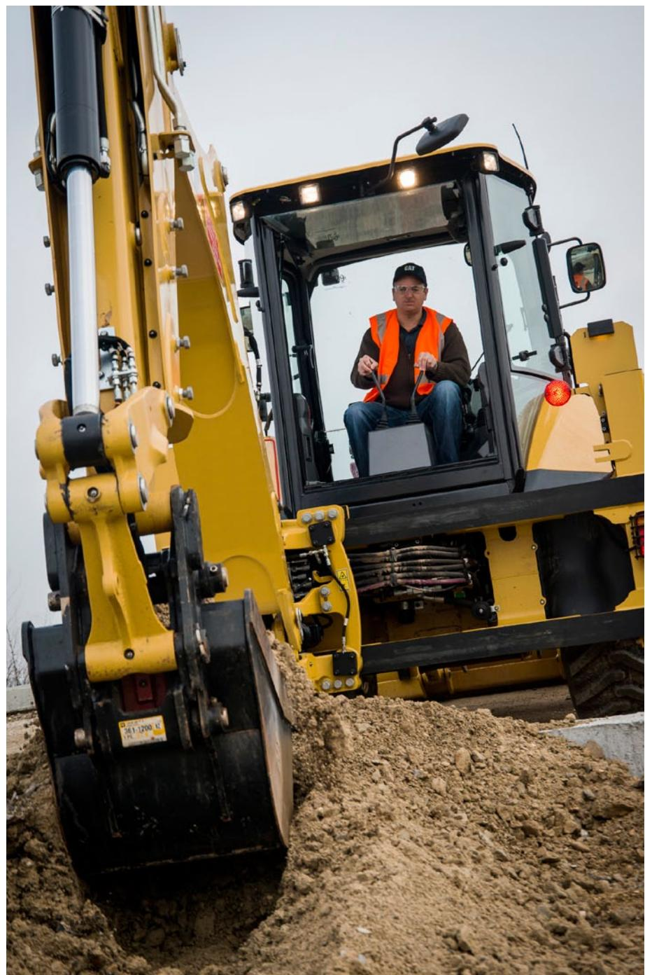
428F2 je opremljen mehaničkim komandama koje obezbeđuju fizički lak rad i mogućnost da se dodirom dugmeta pređe sa rasporeda komandi ISO (bager) na SAE (rovokopač) i obrnuto. Obezbeđuje lak i bezbedan rad za rukovaoce različitih nivoa iskustva i sposobnosti.
