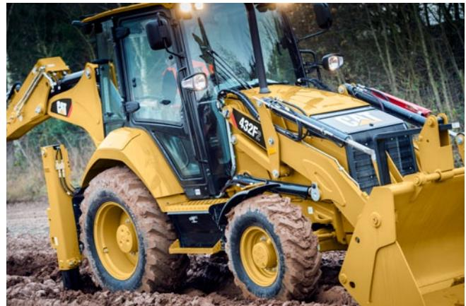
Model 432F je opremljen regulacionim kontrolama koje omogućavaju rad uz mali napor, uz mogućnost prebacivanja između rasporeda kontrola ISO (bager) ili SAE (rovokopač) na pritisak dugmeta. Obezbeđuje lak i bezbedan rad za rukovače različitih nivoa iskustva i sposobnosti.
