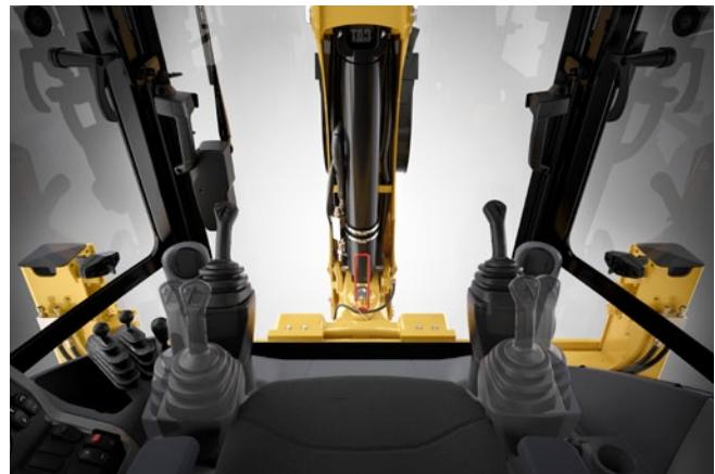
444F2 je opremljen pilotskim komandama za upravljanje bez napora, s mogućnošću odabira modela upravljanja ISO (bager) ili SAE (rovokopač) pritiskom na gumb. Jednostavno i sigurno rukovanje za strojare svih razina iskustva ili sposobnosti.
