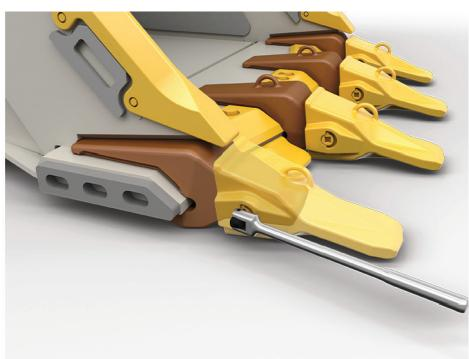
Šira gornja površina smanjuje bočno povlačenje navlaka i adaptera dok se navlaka pomjera kroz tlo. Smanjenje bočnog povlačenja ima za rezultat manje sile potrebne za pomjeranje korpe kroz tlo.
