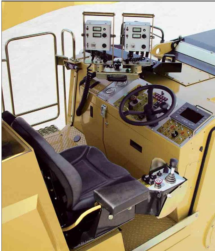
**Ergonomска kabina rukovaoca.** Kabina pune širine omogućava rukovaocu vidljivost prednjeg utovarnog konvejera i bočnih ploča radi obezbeđivanja preciznog i brzog postavljanja.
