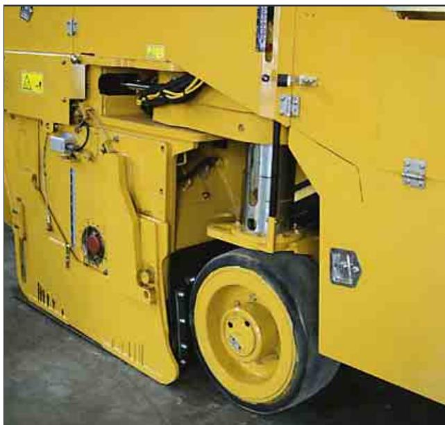
**Puna vučna sila.** Hidrostaticki menjac na sva četiri točka, preko razdvajača toka, i prednja osovina sa samoporavnjanjem obezbeđuju sigurnu vučnu силу и optimalne performanse u svim primenama.
