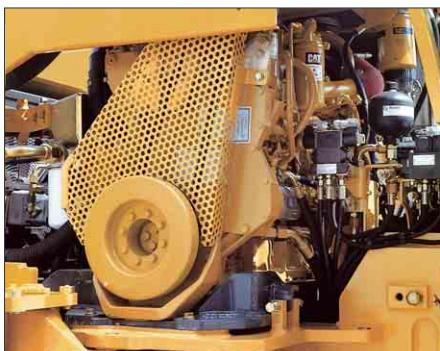
Velika servisna vrata motora obezbeđuju optimalan pristup do motora i hidrauličkih komponenti od nivoa tla.
