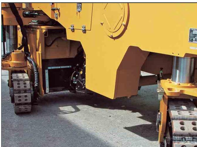
**Precizna kontrola.** Mikroprocesor elektronski kontroliše ugao upravljanja zadnjeg desnog lanca. Ugao upravljanja zadnjeg lanca je automatski podešen u odnosu na položaj prednjih lanaca.
