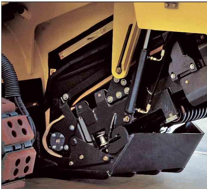
**Optimalna veličina i gradacija materijala.** Hidraulički uređaj za razbijanje komada sprečava odizanje od površine puta, obezbeđuje optimalnu veličinu i gradaciju materijala, štiti sakupljački konvejer i obezbeđuje optimalan otvor za istovar do komore rotora.
