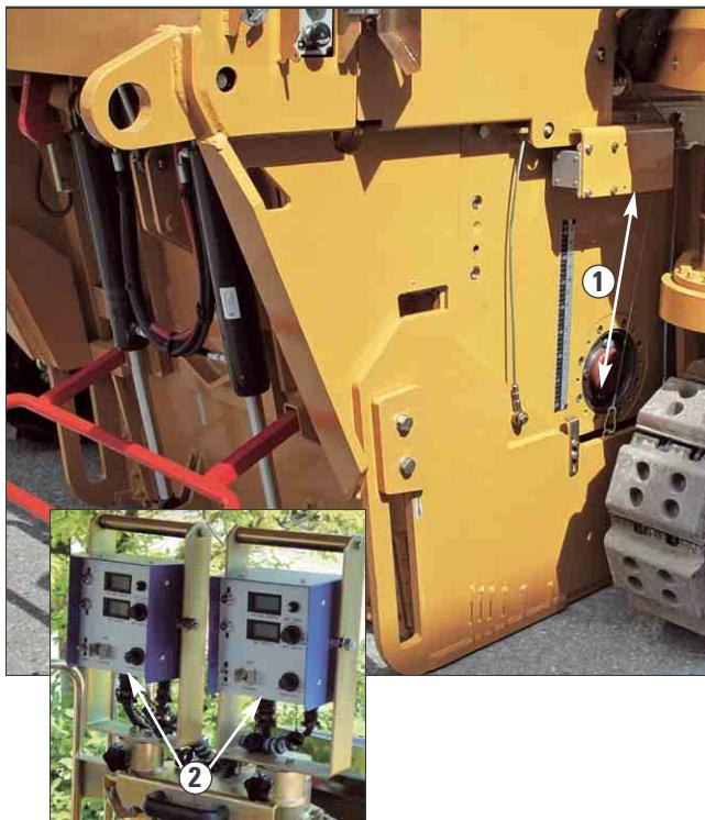
**Žičani (jo-jos) dodirni senzori nagiba.** Žičani senzor nagiba meri pomeranje bočnog zida koji omogućava da kompletan dužinu bočnog zida postane poravnat uređaj radi preciznog prilagođavanja nagiba. Senzor ukrštenog nagiba povećava svestranost sistema.
