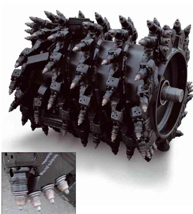
**97 alata sa karbidnim vrhovima.** Alati su ugrađeni u izdržljive trodelne, brzo-otpuštajuće držače alata i uređeni su u trostruko spiralni raspored radi maksimalne sile razlamanja.
