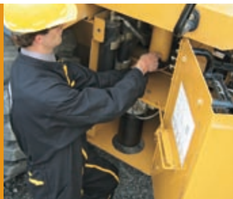
Vsakanje vzdrževanje je poenostavljeno s servisnimi točkami na nivoju tal, ki združujejo vse elektronske, mazalne in tlačne točke in filtre.
