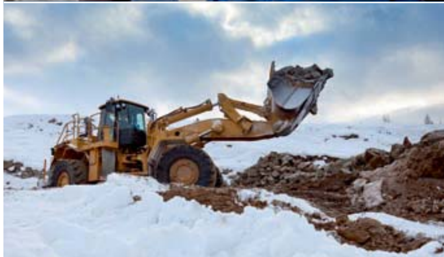
CAT-ovi utovarivači točkaši 988H (iznad) i motorne brusilice 16H imaju ključnu ulogu u izgradnji i održavanju transportnih puteva dugih 150 km.
