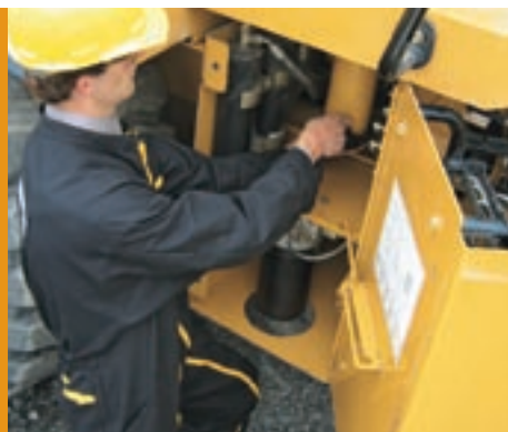
Svakodnevno održavanje se može izvoditi sa razine tla, zahvaljujući grupiranju mjesta servisiranja, elektronike, podmazivanja i tlačnih priključaka i filtera.
