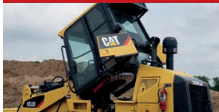
Nagibna kabina omogućava lak pristup pogonskom agregatu i olakšava održavanje i popravke.
