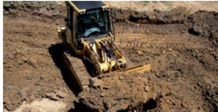
Zahvaljujući hidrostatickom pogonskom agregatu, prijenos snage na oba lanca omogućava odlične manevarske sposobnosti, čak i na mekom tlu.
