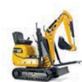
Најкомпактната машина на Cat: 1,507 мм висока и 730 мм широка.
