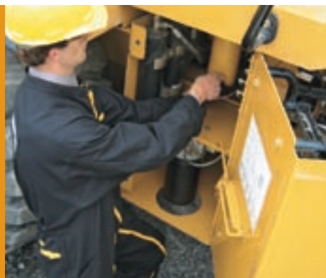
Dnevni servis je olakšan sa servisnih mesta na nivou tla koji grupišu zajedno sva mesta elektronike, maziva i pritiska, kao i filtere.
