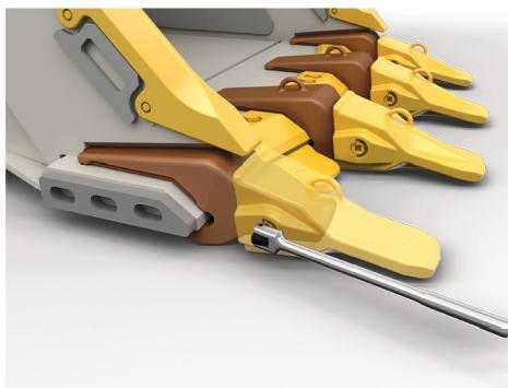
Šira gornja površina smanjuje bočni otpor navlake i adaptera dok se kreću kroz tlo. Smanjenje bočnog otpora rezultira manjim silama potrebnim za kretanje korpe kroz tlo.
