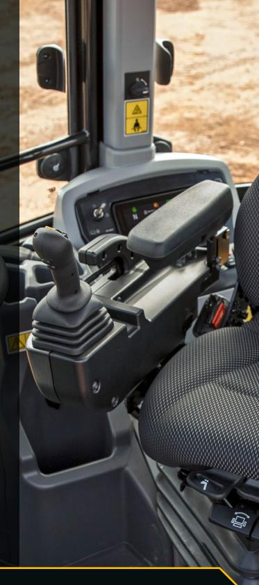
"THE BIGGEST ADVANTAGE IS INTEGRATED JOYSTICKS. YOU CAN WORK WITH THE SEAT BEING PARTIALLY TURNED. THERE IS VERY GOOD VISIBILITY FOR BACKHOE ATTACHMENTS."
