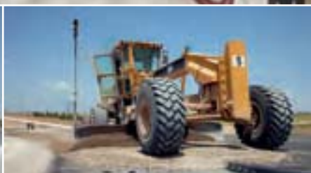
150. KM Postopek izravnavanja z motor grederjem 16H
