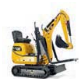
Najkompaktniji Catov stroj: visok 1.507 mm i širok 730 mm.
