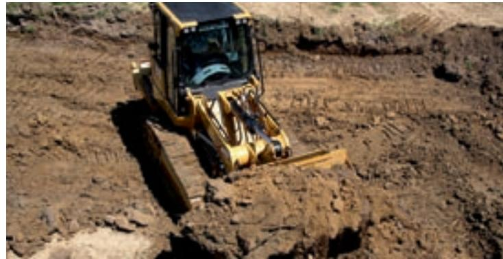
Zahvaljujući hidrostatičkom pogonskom mehanizmu, okretanja pod punim pogonom koja koriste oba lanca obezbeđuju odličnu mogućnost manevriranja čak i na mekoj podlozi.
