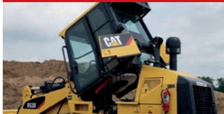
Kabina koja se može nakretati daje lak pristup do pogonskog mehanizma i olakšava održavanje i popravke.
